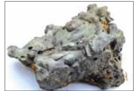
Schlacke, deutlich das Fließmuster des flüssigen Gesteins, Lava-ähnlich mit poröser Struktur
